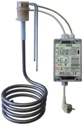
**Titan-Heizstab** mit angebautem Niveau/Trockenheizschutz-Elektroden-/Temperatur-Fühler und Temperatur-Begrenzer-Fühler zur vollautomatischen Steuerung. Somit können Sie Ihre Behälter gegen Trockenlauf, Überhitzung und Brandgefahr schützen, Ihre Flüssigkeit automatisch regeln, heizen, überwachen und begrenzen. Heizstab auch aus Edelstahl lieferbar.
