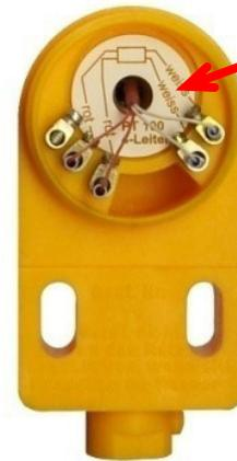
Einblick in einen geöffneten Temperaturfühler-Anschlusskopf. Ersichtlich sind die übersichtlich, montagefreundlich und leicht zugänglich angeordneten Klemmen mit Anschlusschema.
