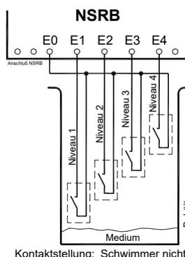
Beim NSRB-Gerät können Schwimmerschalter anstelle der Trockenheizschutz-, Niveau- und Überlauf-Elektroden angeschlossen werden. Beachten Sie dabei, dass aufsteigend jeweils ein Schliesserkontakt angeschlossen wird (Bei Schwimmerschaltern mit Umschaltkontakten nur Schliesser verwenden!) Der Poti „Empfindlichkeit“ auf der Geräte-Frontseite soll in Mittelstellung sein. Einstellbereich 0-50 kΩ
