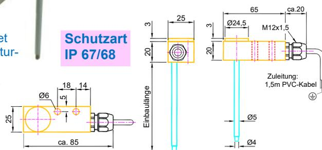
Der Anschlusskopf und Befestigungshalter bestehen aus einem Teil und bilden eine Baueinheit. Der Anschlusskopf kann von der aufsteigenden Flüssigkeit nicht berührt werden, da diese vorher über den Behälterrand abläuft. Siehe Foto oben.
