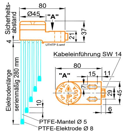
Für eine vollständige Trockenheizschutz/ Niveausteuerng wird zusätzlich zu dem oben abgebildetem Anschlusskopf mit Stabelektroden noch ein elektronisches Schaltrelais benötigt. An welches Relais diese Stabelektroden angeschlossen werden können, zeigt das Foto auf Seite 48 und die Beschreibung bis Seite 57.
