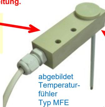
Bei Befestigung am Behälterrand können durch aufsteigende Flüssigkeit die elektrischen Kontakte nicht außer Funktion gesetzt werden, da die Flüssigkeit vorher über den Behälterrand abläuft.
