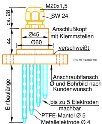
abgebildet: einschraubbare Trockenheizschutz/ Niveau-Stabelektrode aus **Edelstahl** mit Gew.-Nippel 1 ½" und Abdeckkappe aus **Edelstahl**.
