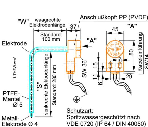
Temperaturfühler am Behälterrand montiert. Bei Bestellung bitte Behälterrandbreite angeben.
