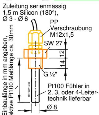
mit Tauchrohr und Gew.-Nippel G 1/2" aus Polypropylen (PP) Ø 10mm und Kabelverschraubung aus PP. Einsetzbar bis ca. 90°C **Preis / Stück €**
