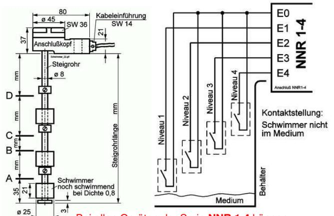
Bei allen Geräten der Serie NNR 1-4 können Schwimmerschalter anstelle der Trockenlaufschutz- / Niveau- Elektroden angeschlossen werden. Beachten Sie dabei, dass aufsteigend jeweils ein Schliesserkontakt angeschlossen wird. (Bei Schwimmerschaltern mit Umschaltschalter nur Schliesser verwenden!) Der Poti „Empfindlichkeit“ auf der Geräte-Frontseite soll in Mittelstellung sein. Einstellbereich 0-150 kΩ. Darstellung: Schwimmerschalter mit 4 Schliessern
