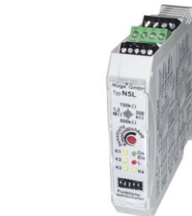
Für erhöhte Sicherheit: Niveaus-Schaltrelais N5L mit Leitungs-Überwachung. Damit kann die Elektrodenanschlussleitung auf Unterbrechung überwacht werden. Einstellempfindlichkeit 0 bis 1,2MΩ. 4 Empfindlichkeitsbereiche sind einstellbar. 4 unabhängige Schaltpunkte plus Masse-Referenzkontakt.
