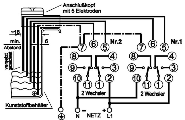
**Bild 8** Die längste Elektrode als Schutzleiter/Masse Referenzkontakt (Klemme 7) im Behälter verwenden.
