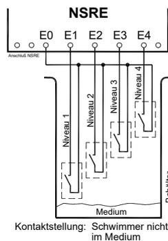
Beim NSRE-Gerät können Schwimmerschalter anstelle der Trockenheizschutz-, Niveau und Überlauf- Elektroden angeschlossen werden. Beachten Sie dabei, dass aufsteigend jeweils ein Schliesserkontakt angeschlossen wird (Bei Schwimmerschaltern mit Umschaltkontakten nur Schliessers verwenden!) Der Poti „Empfindlichkeit“ auf der Geräte-Frontseite soll in Mittelstellung sein. Einstellbereich 0-50 kΩ
