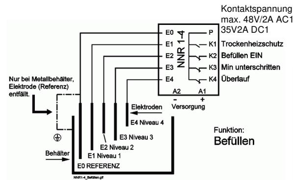
Gezeichnete Schaltstellung: Betriebsspannung liegt an und alle Elektroden ohne Kontakt zum Medium
