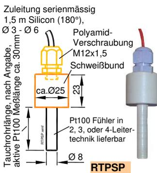
mit Tauchrohrmantel und Anschweißbund aus Polypropylen (PP) Ø 10mm und Kabel-Verschraubung aus PP. Einsetzbar bis ca. 90°C **Preis / Stück €**
