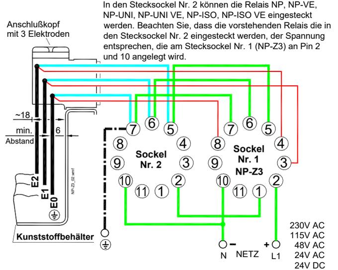
**Achtung:** Der im obigem Bild 1 und 2 eingezeichnete Steuerstromkreis (Socket Nr. 1) betrifft nur das NP-Z3 Relais (siehe Farbe **Rot und Grün**). Die Funktion im Socket Nr. 2 ist vom Anwender nach seinen Wünschen bzw. der dazugehörigen Gebrauchsanweisung vom Relais Typ, das in das obige Anschlussbeispiel Socket-Nr. 2 eingesteckt wird (gemäß Farbe **Blau**) zu verdrahten.
