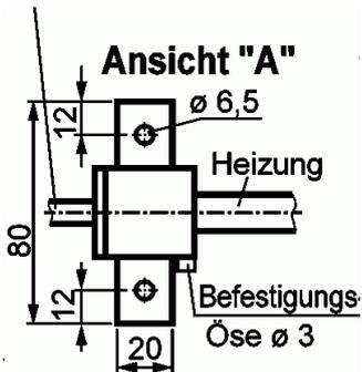
Befestigungsstreifen unterhalb Anschlusskopf verschweißt.
