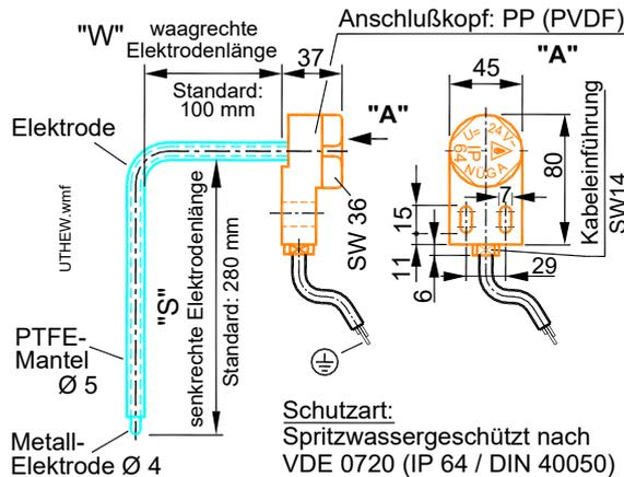
Für eine vollständige Trockenheizschutz/ Niveausteuern wird zusätzlich zu dem oben abgebildeten Anschlusskopf mit Stabelektroden noch ein elektronisches Schaltrelais benötigt. An welche Relais oder andere Geräte diese Stabelektroden angeschlossen werden können, zeigen die Fotos auf Seite 44.
