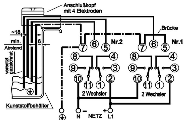
**Bild 6** Die längste Elektrode als Schutzleiter/Masse Referenzkontakt (Klemme 7) im Behälter verwenden. Brücke zwischen Klemme 5 und 7 nicht vergessen.
