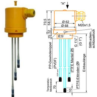
Best.-Nr. DDT mit PVDF Gew.-Nippel Kabelabgang seitlich. Die Elektrodenlängen bei der Bestellung angegeben sie können nicht gekürzt werden
