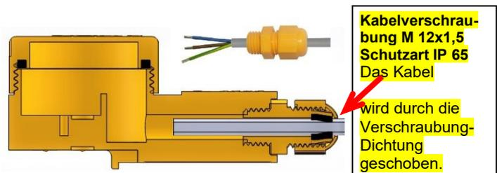
Das Foto zeigt die zigtausend-fach bewährte **NÜGA-Serien-Kabelverschraubung**. Durch die ca. 24mm tief und geschützt im Kabelkanal angeordnete Dichtung sowie die über den Kabelmantel geschobene Dichtung (siehe obige Kabelnippel-Abbildung) wird nach korrekter und festgeschraubter Kabelnippel-Montage die hohe **Schutzart IP 67/68** erreicht.
