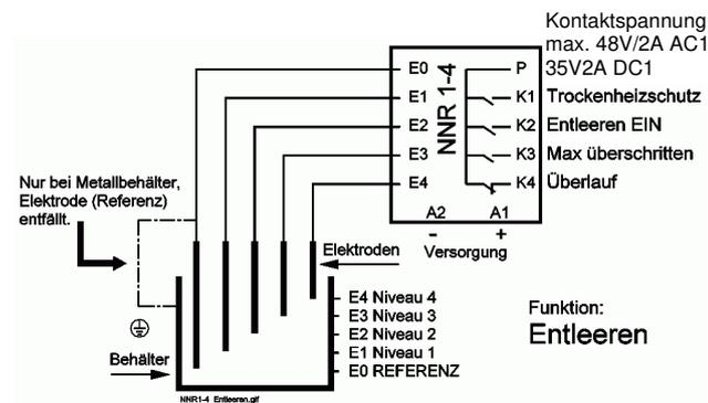
Gezeichnete Schaltstellung: Betriebsspannung liegt an und alle Elektroden ohne Kontakt zum Medium
