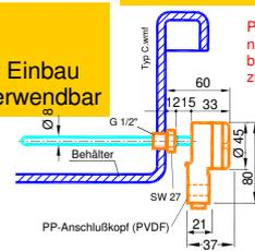
PP-Anschlusskopf (PVDF) darf nicht abgedeckt sein. Umgebungstemperatur im Betriebszustand - 10 bis + 25°C
