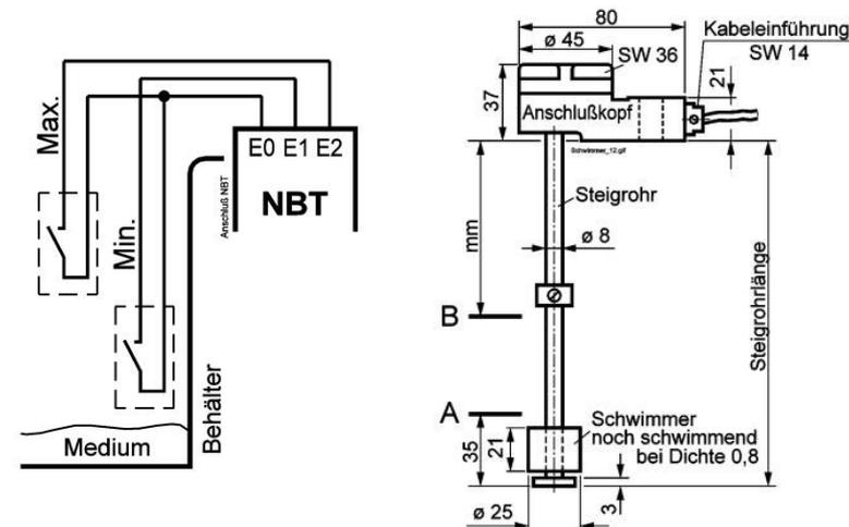
Bei allen Geräten der Serie NBT können Schwimmerschalter anstelle der Trockenheizschutz- / Überlauf- Elektroden angeschlossen werden. Beachten Sie dabei, daß aufsteigend jeweils ein Schliesserkontakt angeschlossen wird (Bei Schwimmerschaltern mit Umschaltkontakten nur Schliesser verwenden!) Der Poti „Empfindlichkeit“ auf der Geräte-Frontseite soll in Mittelstellung sein.
