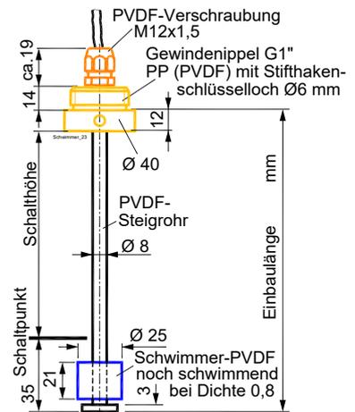
Schwimmer mit PP-Gew. Nippel und Kabelverschraubung
