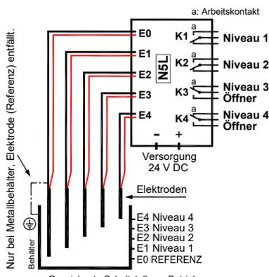
Gezeichnete Schaltstellung: Betriebsspannung liegt an, alle Elektroden ohne Kontakt zum Medium
