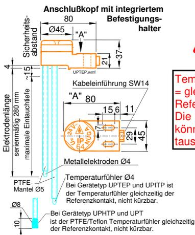
Temperaturfühler = gleichzeitig Referenzkontakt. Die Innenfühler können ausgetauscht werden
