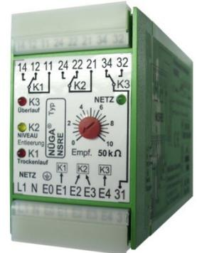
Die Schaltstellungen der drei Ausgangsrelais (250 V / 5 A belastbar, je 1 Wechsler) sind so angelegt, dass auch bei Funktionsstörung oder Defekt ein sehr hohes Maß an Sicherheit erreicht wird.
