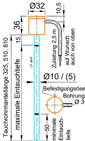
Diese Geräte werden serienmäßig mit seitlichem Kabelabgang und ca. 2,5m PVC-Kabel geliefert. Auf Wunsch Kabelabgang auch von oben. Der Temperaturfühler kann **nicht** gewechselt werden. Der Anschlusskopf ist vergessen. **Schutzart IP 67**
