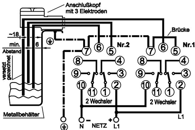
**Bild 5** Den Schutzleiter/ Masse-Referenzkontakt (Klemme 7) mit dem Metallbehälter verbinden
