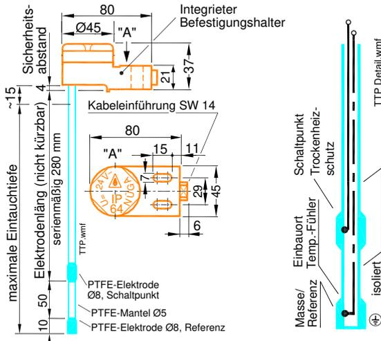
Diese vollständig ummantelten PTFE/Graphit-Elektroden (leitfähig am schwarzen Elektrodenanschaltkontakt) können in höchst aggressiven Flüssigkeiten eingesetzt werden. Sie können bauseits nicht gekürzt werden. Die gewünschten Elektrodenlängen müssen bei der Bestellung angegeben werden. Max. Elektrodenspannung/-strom: 24V/20mA.
