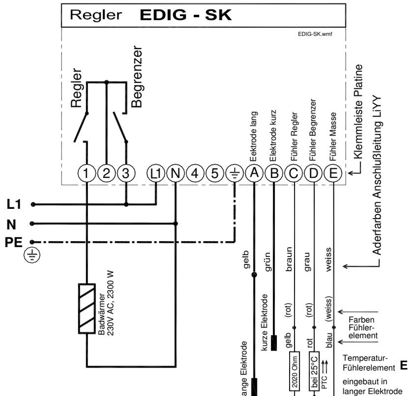
Mit geringem Aufwand kann anstatt der Trockenheizschutz / Niveau - Elektroden Klemme A, B auch ein Schwimmerschalter angeschlossen werden.
