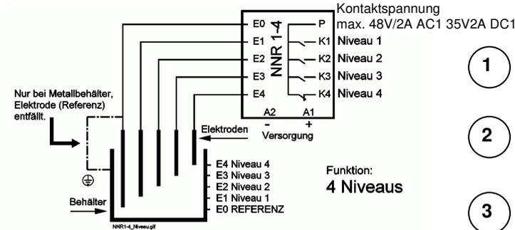
Gezeichnete Schaltstellung: Betriebsspannung liegt an und alle Elektroden ohne Kontakt zum Medium
