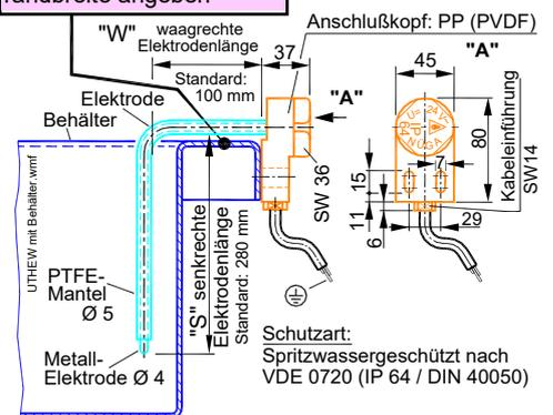
Diese Geräte (elektrische Signalgeber) werden bevorzugt bei Bädern mit hoher Flüssigkeitstemperatur, starker Dampfentwicklung usw. eingesetzt und, wenn oben am Behälterranda kein Platz zum Anschrauben für den Anschlusskopf vorhanden ist.
