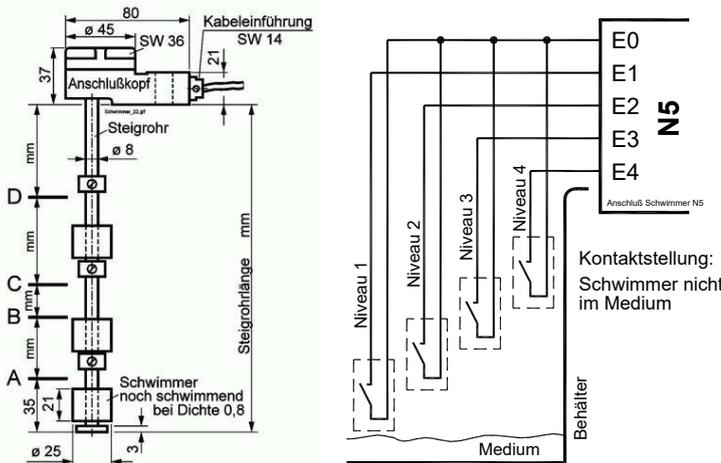
Der Reed-Kontakt im Schwimmerschalter wird wie folgt belastet:
