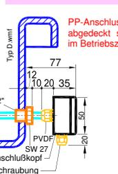
PP-Anschlusskopf (PVDF) darf nicht abgedeckt sein. Umgebungstemperatur im Betriebszustand - 10 bis + 25°C
