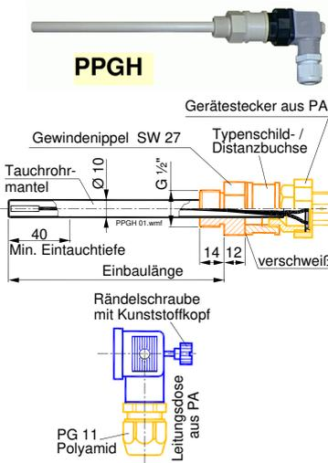
mit Tauchrohr und Gew.-Nippel G 1/2" aus Polypropylen (PP) Ø 10mm, sowie Geräte-Stecker und Leitungsdose aus PA und Kabelverschraubung aus PP. Einsetzbar bis ca. 90°C **Preis / Stück €**
