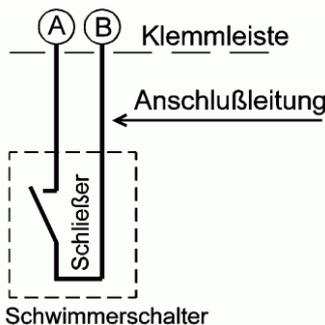
Mit geringem Aufwand kann anstatt der Trockenheizschutz / Niveau-Elektroden Klemme A, B auch ein Schwimmerschalter angeschlossen werden. Bei Schwimmerschalter ist nur ein Schließeranschluss möglich.
