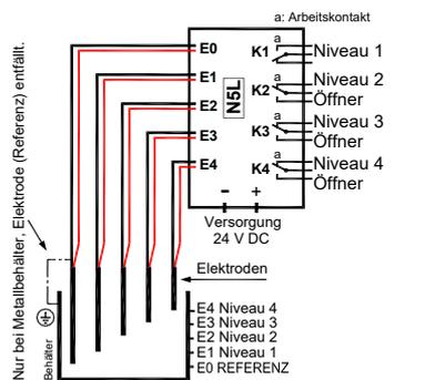
Gezeichnete Schaltstellung: Betriebsspannung liegt an, alle Elektroden ohne Kontakt zum Medium
