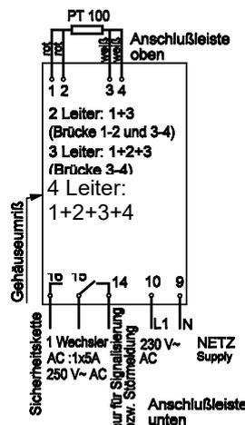
**Achtung:** Sicherheits-Temperaturbegrenzer sind nur in Verbindung mit TÜV-geprüften /zugelassenen Temperaturfühlern zu verwenden. Bei Verwendung nicht zugelassener Temperaturfühler erlischt die Sicherheits-Zulassung nach DIN. Zugelassene Temperaturfühler siehe Seite 39.
