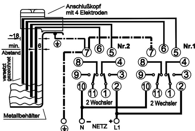
**Bild 7** Den Schutzleiter/ Masse-Referenzkontakt (Klemme 7) mit dem Metallbehälter verbinden
