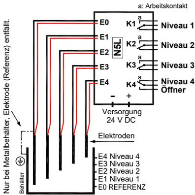
Gezeichnete Schaltstellung: Betriebsspannung liegt an, alle Elektroden ohne Kontakt zum Medium
