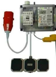
Vollautomatische Steuergeräte EDIG-SK (digital), 1 Schütz bis 7 kW, 1 CEE-Stecker (Netz 3 ~ 10A), 2 CEE-Kupplungen rot oder Schuko-Steckdosen, eingebaut in Kunststoffgehäuse mit Klarsichtdeckel 125 x 175 x 100mm und den Elektroden/Fühler-Anschlußkopf aus (PP).
