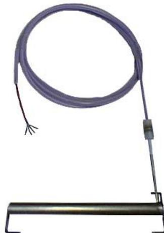
**Tankheizkörper / Behälterheizkörper (Bodenheizung)** mit flexibler (Ø 13mm) PTFE/ (Teflon) ummantelter Zuleitung. Tankhöhe bis ca. 15 Meter, mit großer Leistung (kW) lieferbar. Aus Edelstahl und Titan.
