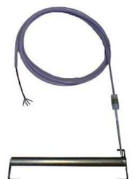
Tankheizkörper / Behälterheizkörper (Bodenheizung) mit flexibler (Ø 13mm) PTFE/ (Teflon) ummantelter Zuleitung. Tankhöhe bis ca. 15 Meter, mit großer Leistung (kW) lieferbar. Aus Edelstahl und Titan. Wasserdicht IP 68
