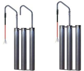
Am Behälterrand einhängbares wasserdichtes (IP68) Kleinheizregister. Die 3 senkrechten Heizrohre benötigen häufig weniger Platz als 2 Badwärmer, da die großen Anschlussköpfe entfallen. Beispiel: Heizleistung pro Heizrohr 4,5kw, Gesamtleistung 13,5kw, Rohr-Ø 57, beheizte Rohrlänge 880mm, Gerätebreite nur ca. 240mm.
