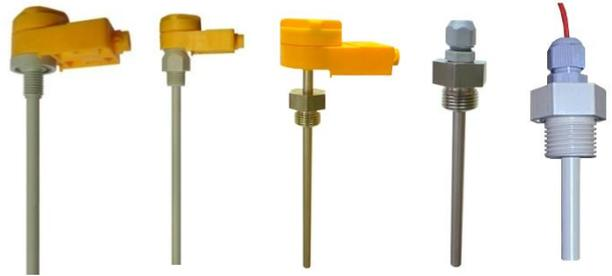
**Einschraubbare Temperaturfühler** (Pt 100, PTC, XTR, XTW usw.) mit Tauchrohren aus PP, PVDF, Edelstahl, Titan. Es sind Gewinde-Nippel G 1/2", G 1", G 1 1/2" M 16 und andere Abmessungen aus PP, PVDF, Edelstahl, Titan lieferbar, auch Sonderanfertigungen sind möglich. Siehe Katalog Temperaturregler
