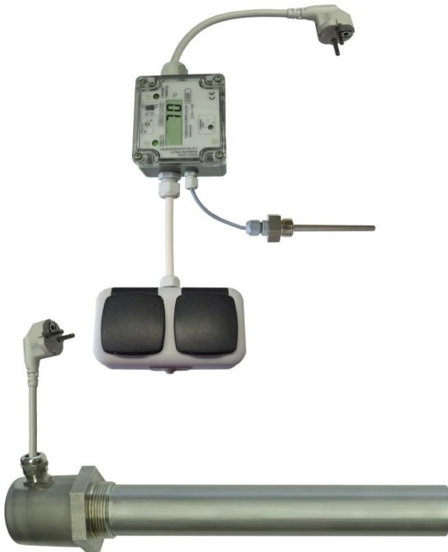
Digital gesteuertes Thermostat Steuergerät im Polykarbonat Gehäuse 80x82x55mm, Schutzart Strahlwasser-geschützt IP 65, angebaut an 2-fach Schukosteckdose und einschraubbarem Tauchrohr aus Edelstahl, Titan, PP, PVDF und PTFE lieferbar (siehe Temperaturfühler-Katalog Seite 88-91).
