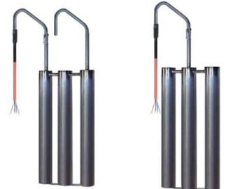
Am Behälterrand einhängbares wasserdichtes (IP68) Kleinheizregister. Die 3 senkrechten Heizrohre benötigen häufig weniger Platz als 2 Badwärmer, da die großen Anschlussköpfe entfallen. Beispiel: Heizleistung pro Heizrohr 4,5kw, Gesamtleistung 13,5kw, Rohr-Ø 57, beheizte Rohrlänge 880mm, Gerätebreite nur ca. 240mm.
