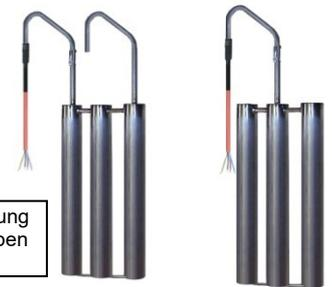
Am Behälterrand einhängbares wasserdichtes (IP68) Kleinheizregister. Die 3 senkrechten Heizrohre benötigen häufig weniger Platz als 2 Badwärmer, da die großen Anschlusshäupte entfallen. Beispiel: Heizleistung pro Heizrohr 4,5kw, Gesamtleistung 13,5kw, Rohr-Ø 57, beheizte Rohrlänge 880mm, Gerätebreite nur ca. 240mm. **Serienabmessungen bis 12 kw Seite 69-1 rechts unten.**
