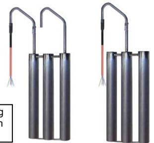
Am Behälterrand einhängbares wasserdichtes (IP68) Kleinheizregister. Die 3 senkrechten Heizrohre benötigen häufig weniger Platz als 2 Badwärmer, da die großen Anschlussköpfe entfallen. Beispiel: Heizleistung pro Heizrohr 4,5kw, Gesamtleistung 13,5kw, Rohr-Ø 57, beheizte Rohrlänge 880mm, Gerätebreite nur ca. 240mm. **Serienabmessungen bis 12 kw Seite 69-1 rechts unten.**
