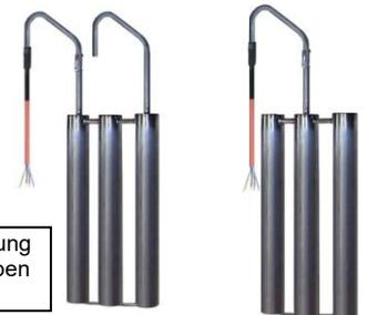
Am Behälterrand einhängbares wasserdichtes (IP68) Kleinheizregister. Die 3 senkrechten Heizrohre benötigen häufig weniger Platz als 2 Badwärmer, da die großen Anschlussköpfe entfallen. Beispiel: Heizleistung pro Heizrohr 4,5kw, Gesamtleistung 13,5kw, Rohr-Ø 57, beheizte Rohrlänge 880mm, Gerätebreite nur ca. 240mm. **Serienabmessungen bis 12 kw Seite 75-1 rechts unten.**
