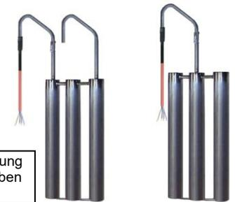
Am Behälterrand einhängbares wasserdichtes (IP68) Kleinheizregister. Die 3 senkrechten Heizrohre benötigen häufig weniger Platz als 2 Badwärmer, da die großen Anschlussköpfe entfallen. Beispiel: Heizleistung pro Heizrohr 4,5kw, Gesamtleistung 13,5kw, Rohr-Ø 57, beheizte Rohrlänge 880mm, Gerätebreite nur ca. 240mm. **Serienabmessungen bis 12 kw Seite 69-1 rechts unten.**
